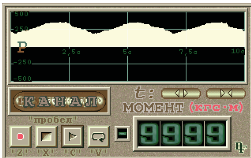
Рис.7. Осциллограмма мощности при осевой нагрузке 160 кН
