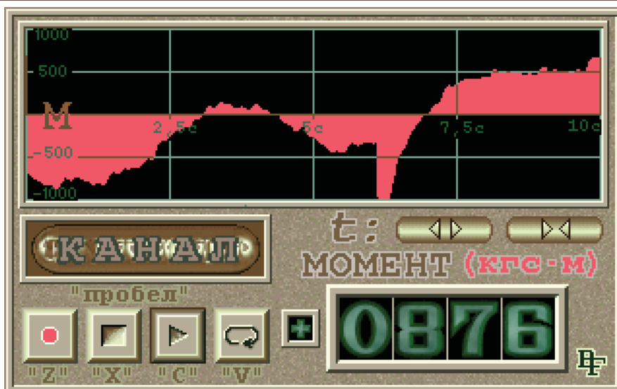
Рис.8. Осциллограмма динамического приращения крутящего момента при осевой нагрузке 160 кН в диапазоне частот каналов измерения мощности и угловой скорости, отличных от частоты квазирезонанса
