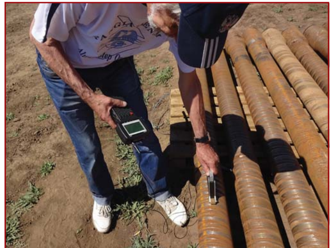
Рис.3. Магнитный контроль напряженного состояния бурильных труб индикатором механического напряжения металла ИН-02 сканирующего типа
