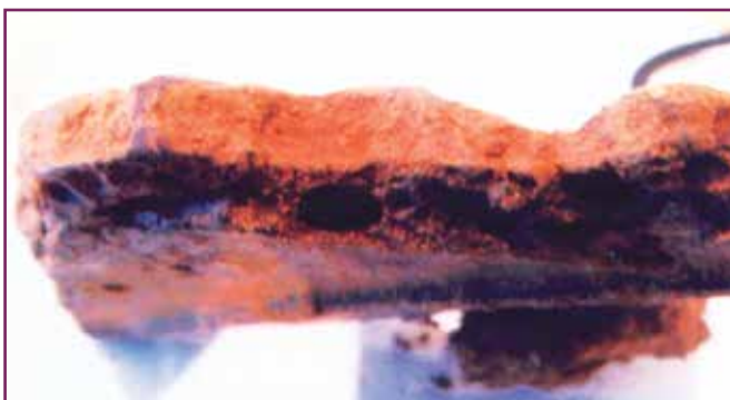
Рис.2. Образец АСПО, отобранный при очищении НКТ. Площадь «Сангачалы-дениз»
