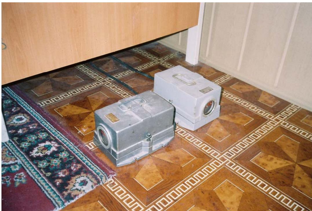
Şək. 1. Seysmoqəbulediciləri 2-ci mərtəbədə yerləşdirilməsi
