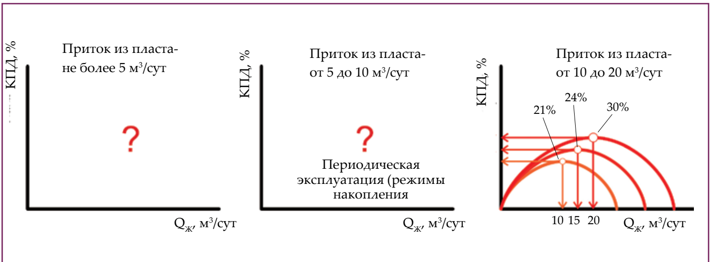
Рис.1. Энергетические характеристики погружных электроцентробежных насосов, в условиях освоения и эксплуатации малодебитных скважин
