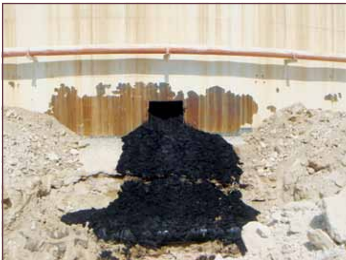
Рис.3. Нефтешлам скопившийся на днище товарного резервуара
