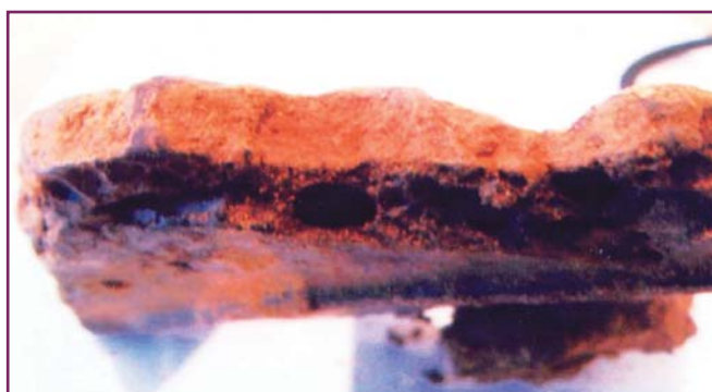
Рис.2. Образец АСПО, отобранный при очищении НКТ. Площадь «Сангачал-дениз»
