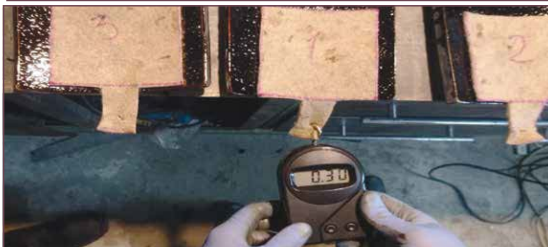
Рис.3. Процесс измерений силы адгезии АСПО к поверхности образцов
