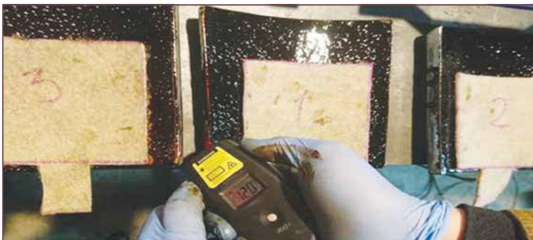
Рис.2. Процесс замера температуры образцов
