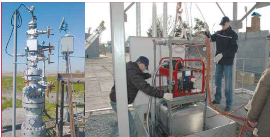
Рис.2. Варианты обеспечения автономного энергообеспечения скважин
