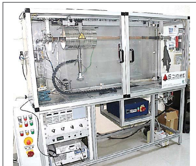
Рис. 5. Лабораторная CVD установка для синтеза углеродных нанотрубок
